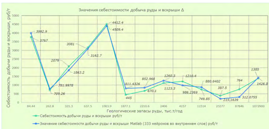
Рис. 3. График значений себестоимости добычи руды и вскрыши (руб./т) по геологическим запасам руды
